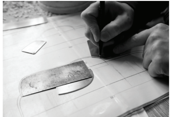
la courbe des coupes pour sévres... en train d'être réajustées directement à la main sur le plan avec Romain le tourneur.
